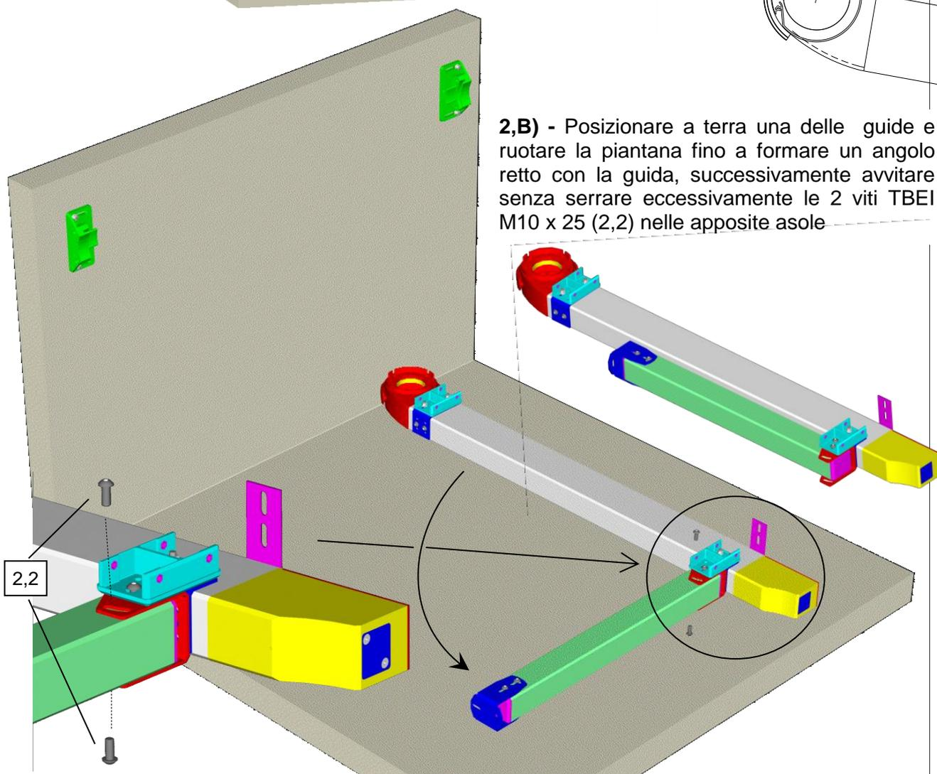
**2,B)** - Posizionare a terra una delle guide e ruotare la piantana fino a formare un angolo retto con la guida, successivamente avvitare senza serrare eccessivamente le 2 viti TBEI M10 x 25 (2,2) nelle apposite asole
