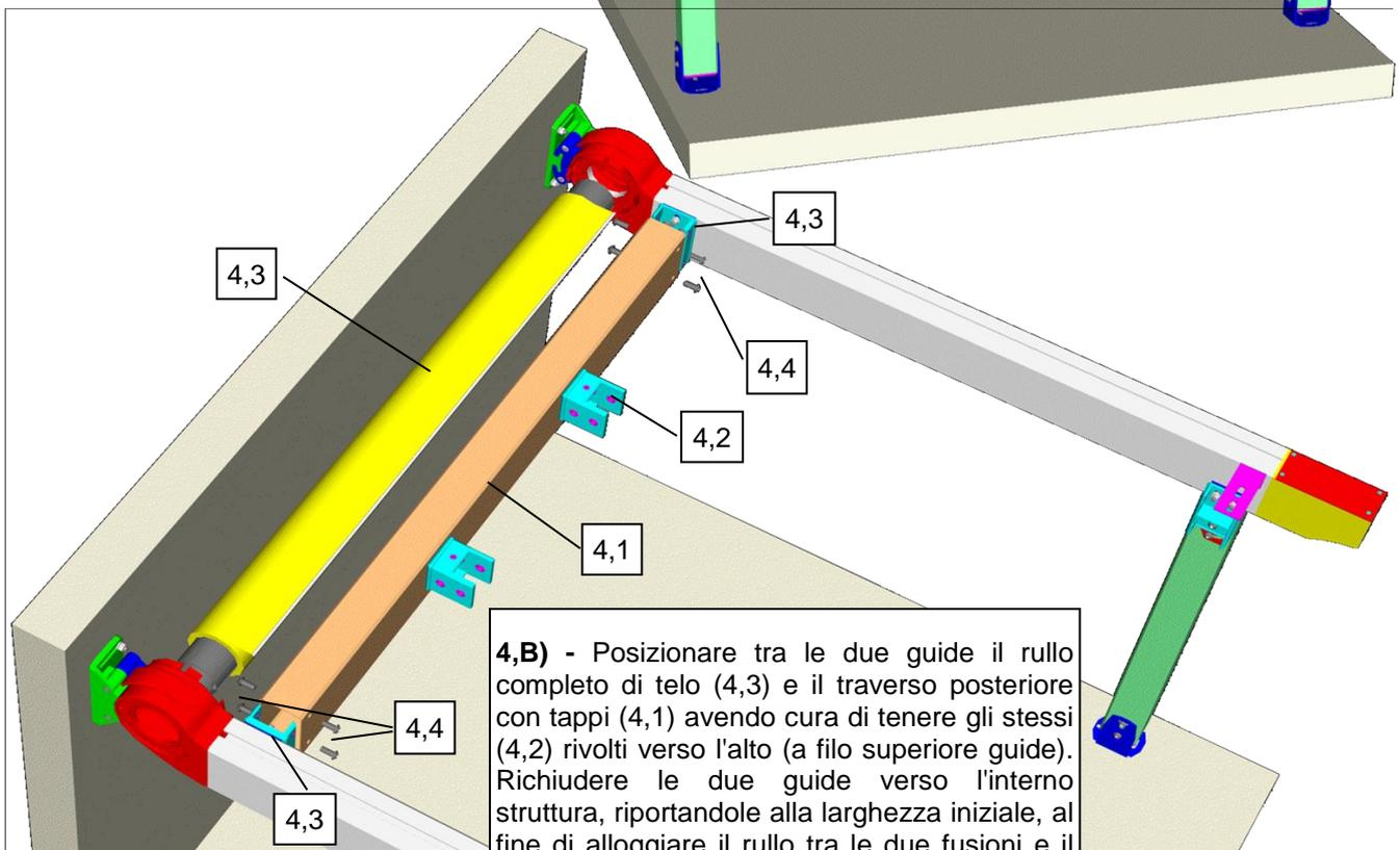
**4,B)** - Posizionare tra le due guide il rullo completo di telo (4,3) e il traverso posteriore con tappi (4,1) avendo cura di tenere gli stessi (4,2) rivolti verso l'alto (a filo superiore guide). Richiudere le due guide verso l'interno struttura, riportandole alla larghezza iniziale, al fine di alloggiare il rullo tra le due fusioni e il traverso posteriore sui due tappi laterali (4,3). Inserire e serrare le 8 viti TBEI M8 x 16 (4,4) negli appositi fori presenti sul traverso posteriore.
