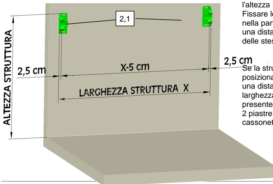
**2,A)** - Posizionare a muro come indicato le 2 piastre laterali di attacco (2,1) ad una distanza corrispondente con la larghezza e l'altezza della struttura finita.
