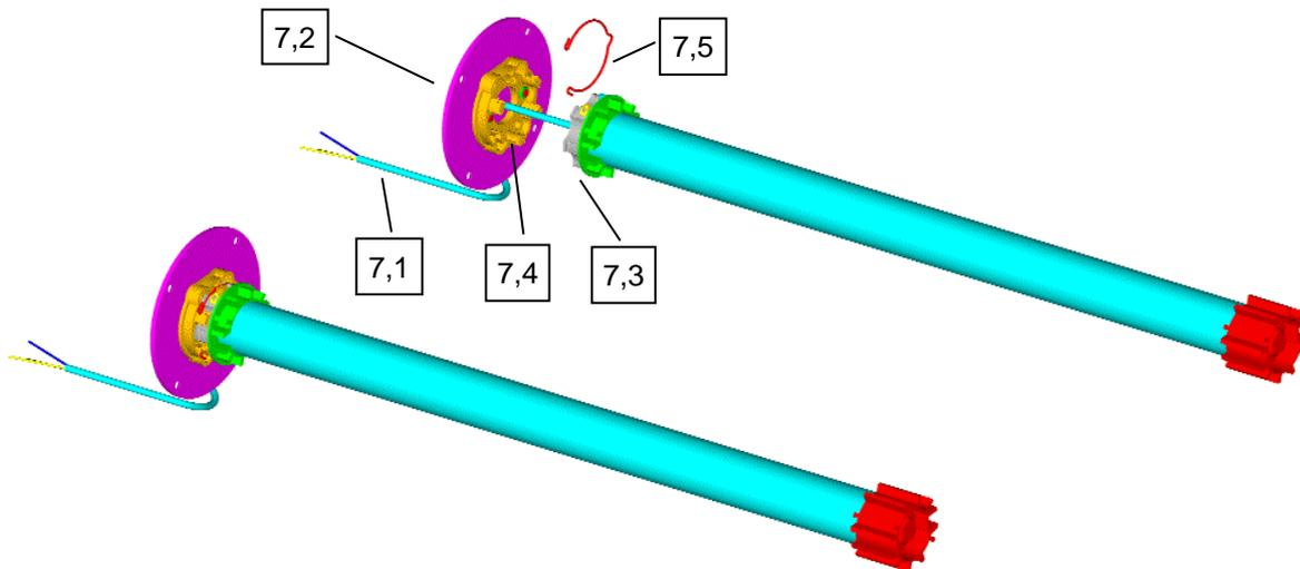
**7,A)** - Prima di inserire il motore nel rullo , bisogna procedere come segue : far scorrere il cavo del motore (7,1) nel foro centrale del coperchio con flangia attacco motore (7,2), alloggiare la testa del motore (7,3) nella flangia attacco motore (7,4) e infine incastrare la molla di sicurezza (7,5) sull'apposita sede presente sulla testa del motore.
