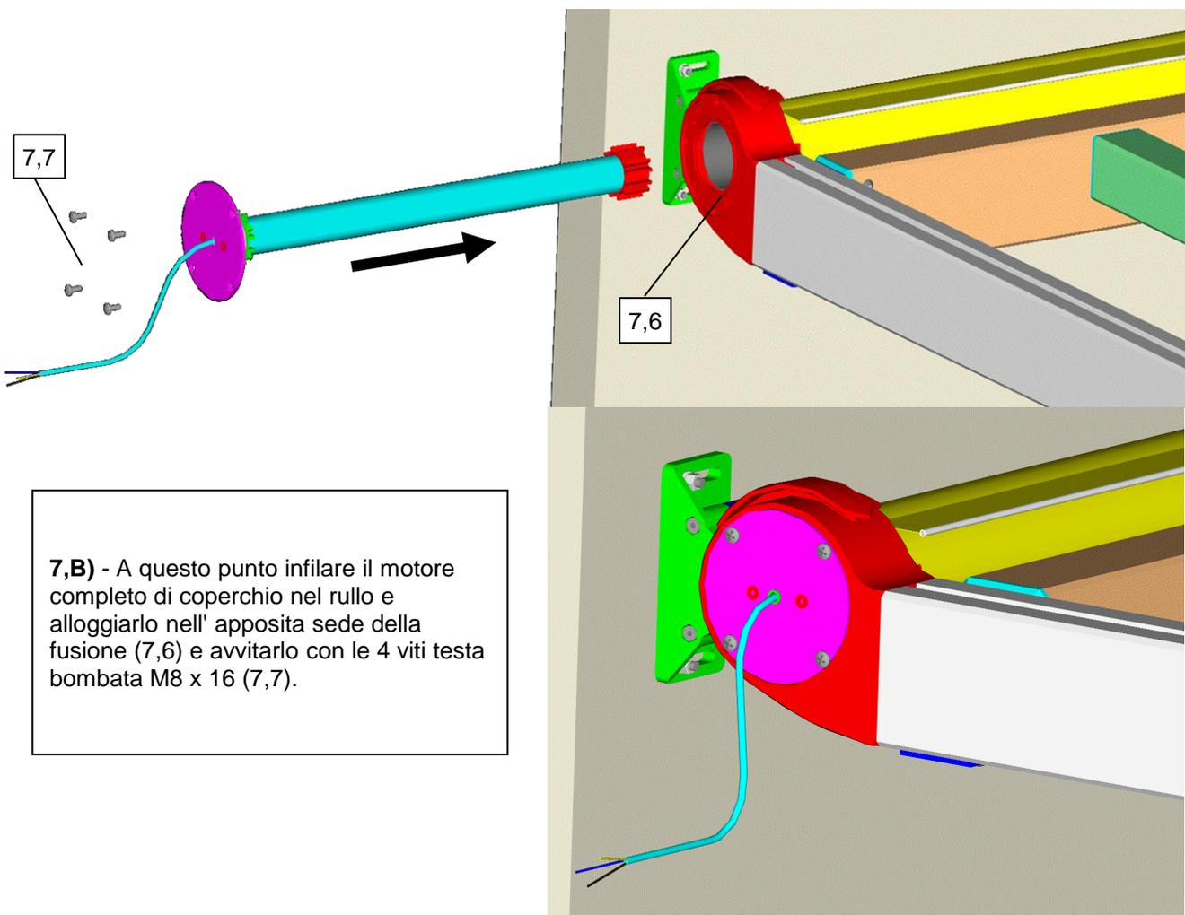
**7,B)** - A questo punto infilare il motore completo di coperchio nel rullo e alloggiarlo nell' apposita sede della fusione (7,6) e avvitare con le 4 viti testa bombata M8 x 16 (7,7).
