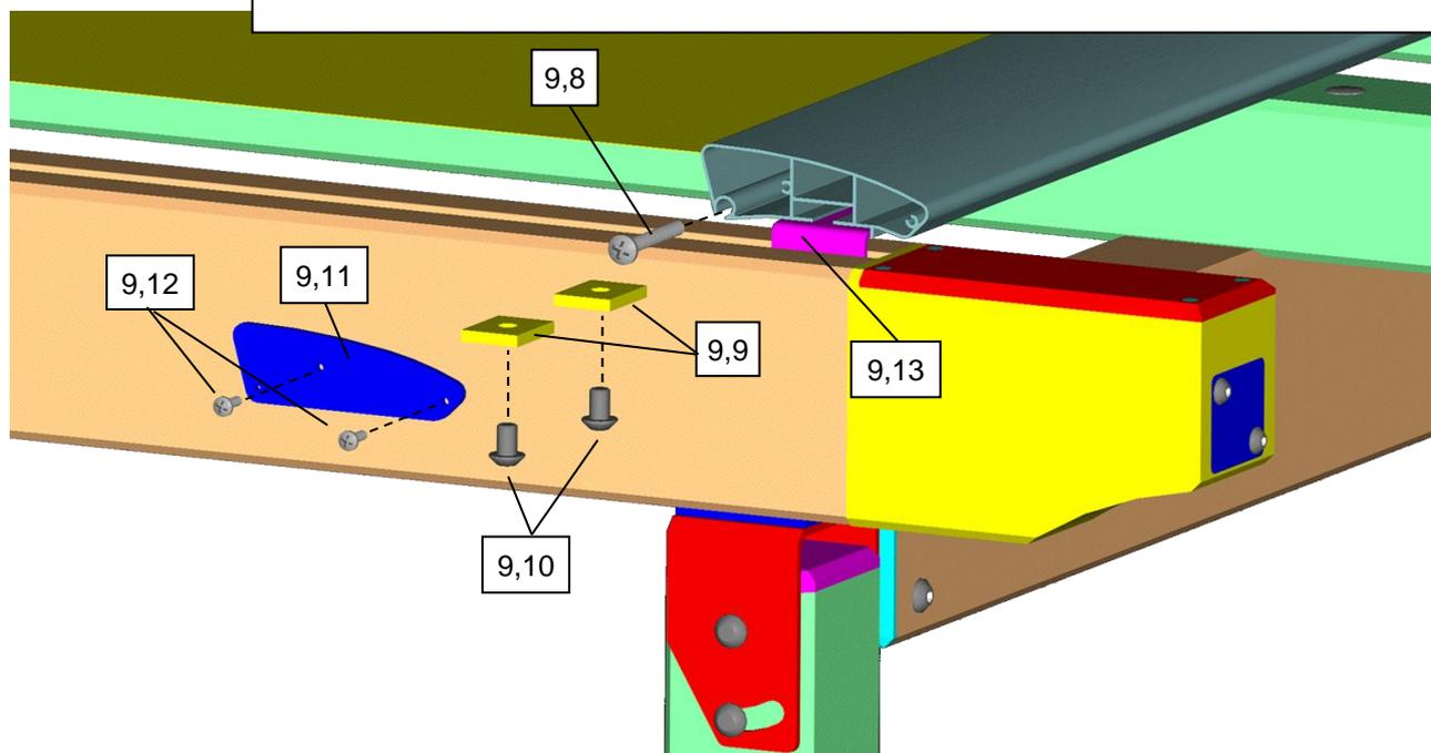
**9,B)** - Centrare il terminale sui due carrelli (9,13). Infilare da ognuno dei due lati del terminale le due piastrine (9,9) nella camera (9,7) e fissarle ai carrelli (9,13) tramite le viti TBEI M10 x 12 (9,10). Avvitare sempre da entrambi i lati del terminale le viti autofilettanti tipo legno (9,8) nella camera del terminale (9,4) al fine di tensionare il telo. Infine fissare i due tappi di chiusura (9,11) alle estremità del terminale utilizzando le viti autoperforanti (9,12).
