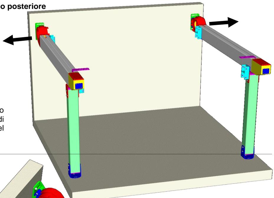
**4,A)** - Allargare il più esterno possibile le 2 guide al fine di permettere l'installazione del rullo e del traverso posteriore.
