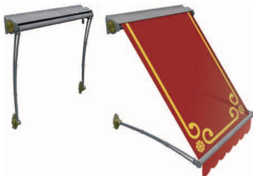
Tenda con bracci rotanti realizzata in ferro battuto forgiato a mano, trattato con zincatura a caldo e verniciato con polveri poliestere secondo rigidi standard qualitativi in tinta grigio ferro micaceo. Tettuccio copritelo in alluminio anch'esso verniciato in tinta grigio ferro micaceo. Telo tinta unita o con decoro. L'eleganza dello stile antico, vuol donare il sapore del passato rivisitato in chiave moderna. Ideale per coprire vetrine e finestre di centri storici o borghi antichi.
