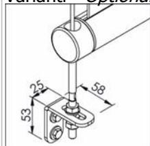
Staffette in acciaio inox AISI 304 per fissaggio al piano verticale.
