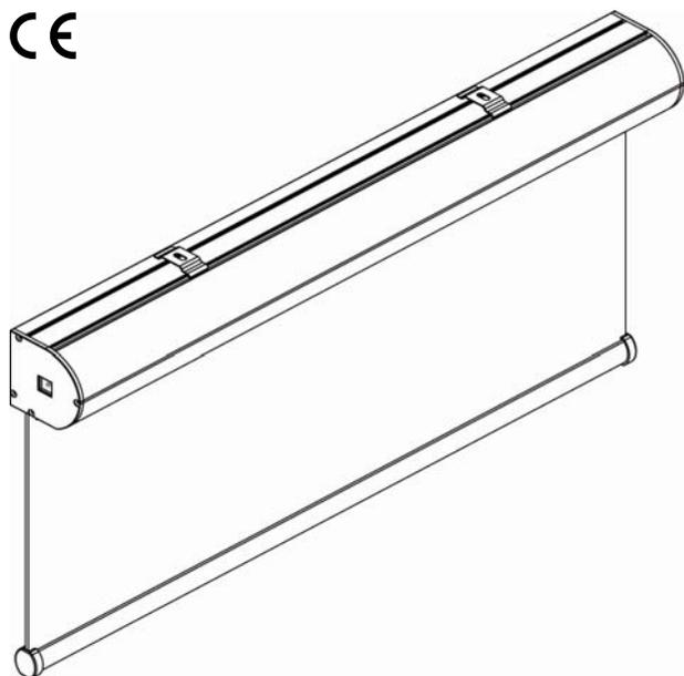
Tenda a rullo con cassonetto e comando di manovra a motore. Motore tubolare monofase 230V/50Hz M40 con regolazione del fine corsa, protezione termica, indice di protezione IP44. Interruttore non fornito. Rullo di avvolgimento Ø 40 mm in alluminio estruso. Cassonetto CT76 in alluminio estruso con veletta di copertura nella parte posteriore. Coppie di testate laterali in plastica bianche e nere. Fondale FR23 in alluminio estruso con tappi in PVC.
