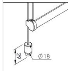
Cavo acciaio inox Ø2,5 mm con tenditore per fissaggio piano orizzontale, con staffe in acciaio per piano verticale.
