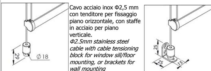
Cavo acciaio inox  $\Phi 2,5$  mm con tenditore per fissaggio piano orizzontale, con staffe in acciaio per piano verticale.
